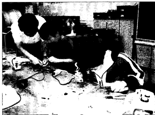
図2 電子部品の半田付けの様子
