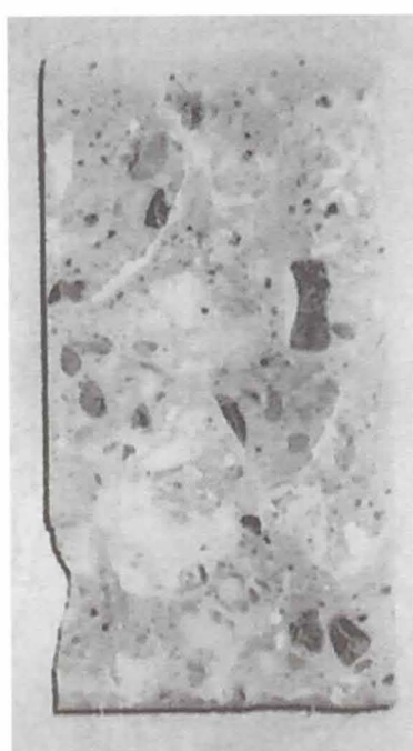
写真2 供試体③の割製断面
