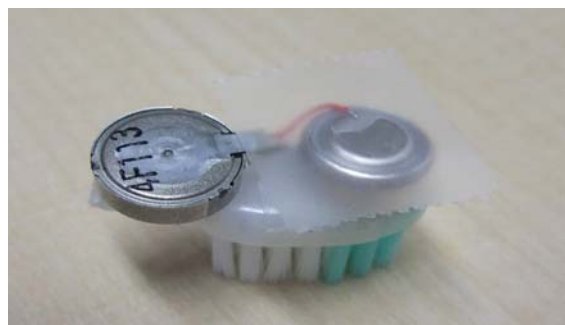
図9 製作した歯ブラシロボット
