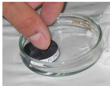
図2 金属組織の腐食
