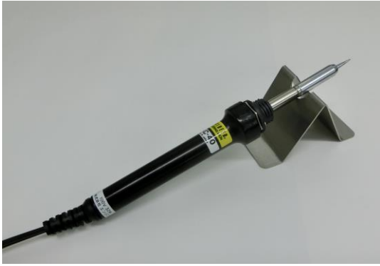
図8 はんだごてを置いた状態
