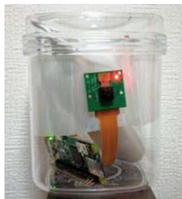
図-3 製作したカメラデバイス
