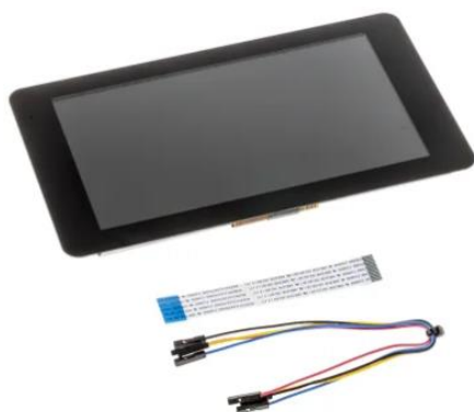
図7 タッチスクリーンディスプレイ (Raspberry Pi 7" Touchscreen Display : element14)
