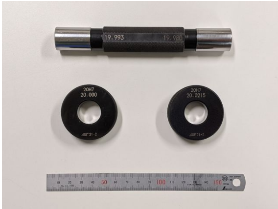
図3 製作したはめあい教材の外観
