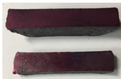
図8 HP \text{LaB}_6 セラミックス焼結体の色彩(赤紫色) (試料: HP プレス圧 28.2MPa)
