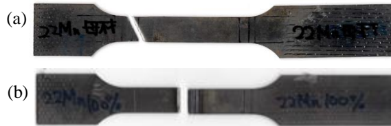
図 1 破断後の引張試験片 10 mm
