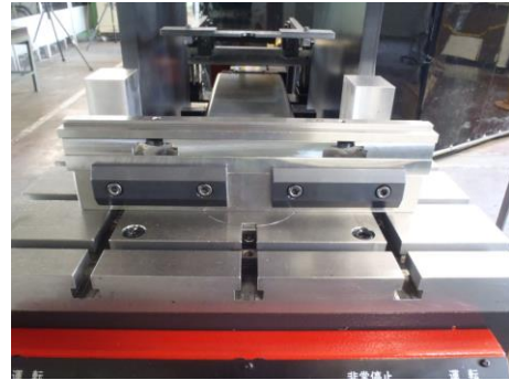
図 10 プレスブレーキのダイホルダー
