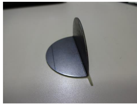
図3 90°曲げ加工後コニカルカップ試験片の外観
