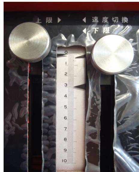
図9 プレスブレーキハンドルの目盛り
