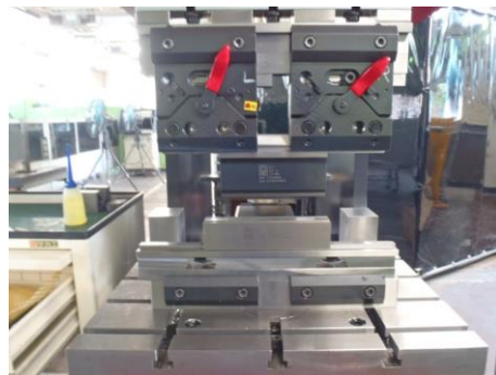
図 12 プレスブレーキのパンチおよび 2V ダイ
