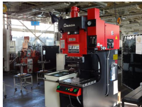
図6 油圧式プレスブレーキ
