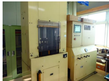
図4 万能塑性加工機
