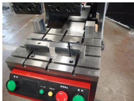
図 13 プレスブレーキのダイホルダーベース
