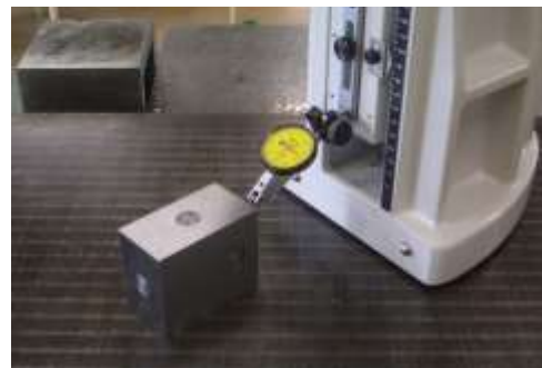
図 5 導入したスコヤマスタによる測定
