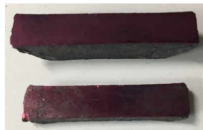
図8 HP \text{LaB}_6 セラミックス焼結体の色彩(赤紫色) (試料: HP プレス圧 28.2MPa)
