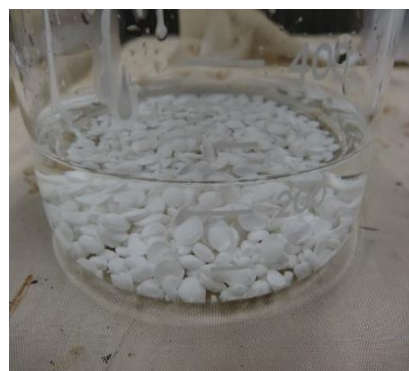
図 1 アルギン酸ナトリウム溶液を用いて TiO 2 粉末を球状成形した顆粒(焼成前の状態)
