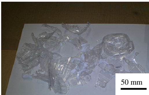
図6 ブレード有りで粉砕後の 500ml ペットボトル ( T=40s )
