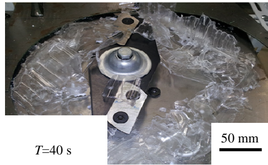
図10 T=40s で粉砕した 2L ペットボトル
