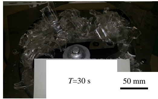
図9 T=30s で粉砕した 2L ペットボトル
