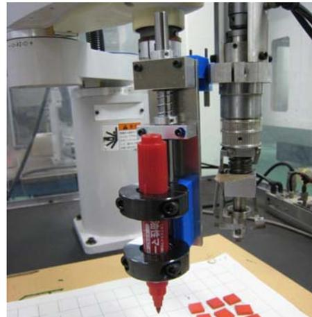
図 3 試作したホルダ
