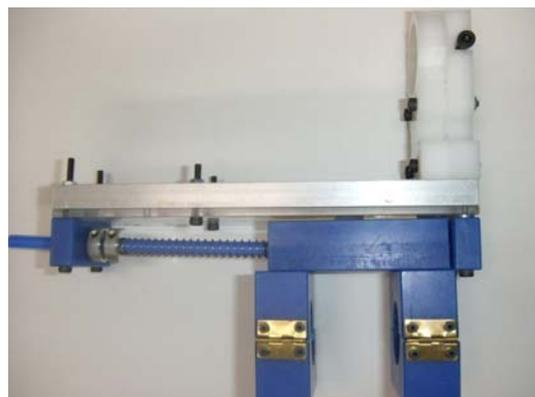
図7 ヤマハ社製ロボット用ホルダ(短)
