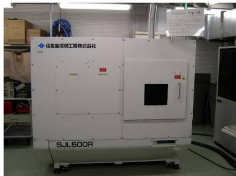
図 1 YAG レーザ加工装置(住友重機械製 JK702H 型)
