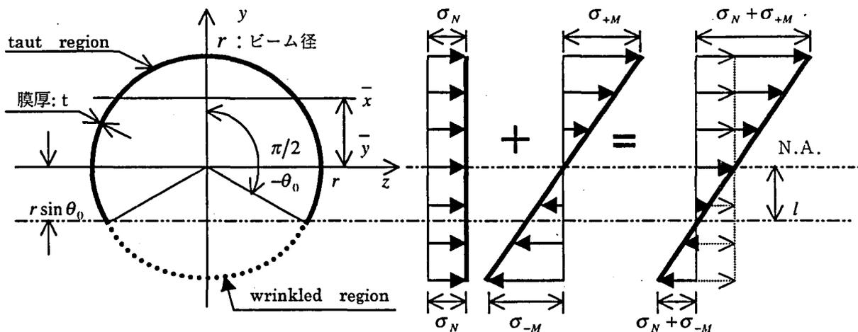
図-2 エア・ビーム断面の応力状態
