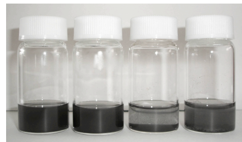
クロロホルム DMF 水 メタノール 図 3 PEG 修飾 VGCF の各種溶媒への分散化
