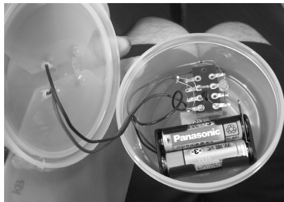
図4 タッパーに回路を納めた様子
