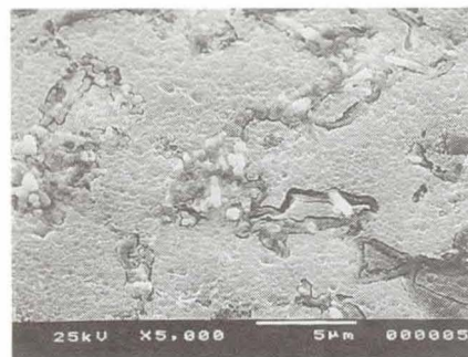
写真1 押し出し材の走査電子顕微鏡組織 (SiCウィスカー10%)
