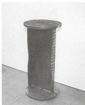
写真4 座屈後供試体
