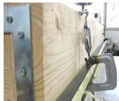
写真2 治具によるシートの定着状態
