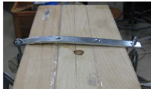
写真3 はり上部の有孔金属板の変形（曲げ変形）状態
