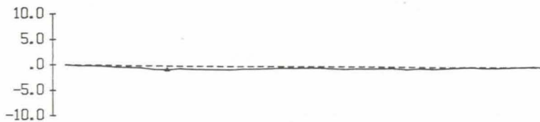
図 3 柱初期たわみ分布図 (供試体 H)
