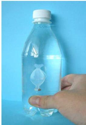
図 1 「指で押すと沈む魚(浮沈子)」の完成品
