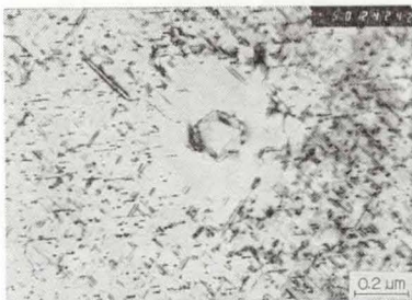
写真6 溶体化処理後175°Cで24時間時効処理した試料に見られた晶出物(希土類元素0.2%)
