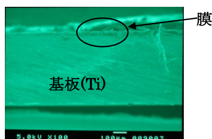
図 17 内熱式 CVD 破断面観察 Ti ( 700^\circ\text{C} )
