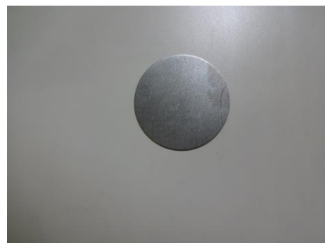
図 1 コンカルカップ試験片の外観
