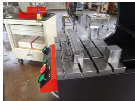
図 11 プレスブレーキのダイホルダー側面
