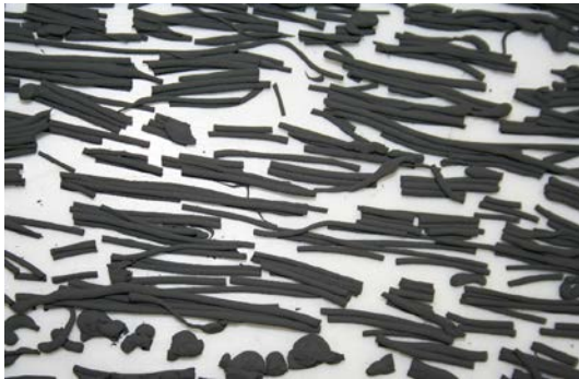
図3 繊維化した乾燥ゲル(直径1mm程度)
