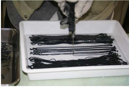
図2 注射器を用いたスラリーの繊維化による配向処理
