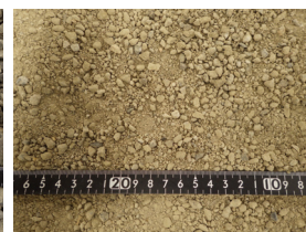
写真 2 5(mm)ふるいを通過した RC40 材
