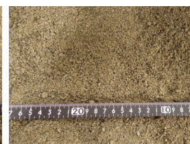
写真 4 RC 材に混合した再生細骨材( S_a )
