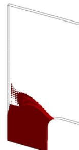
図 28 塑性部分(板厚 20mm) 孔径 480×500mm
